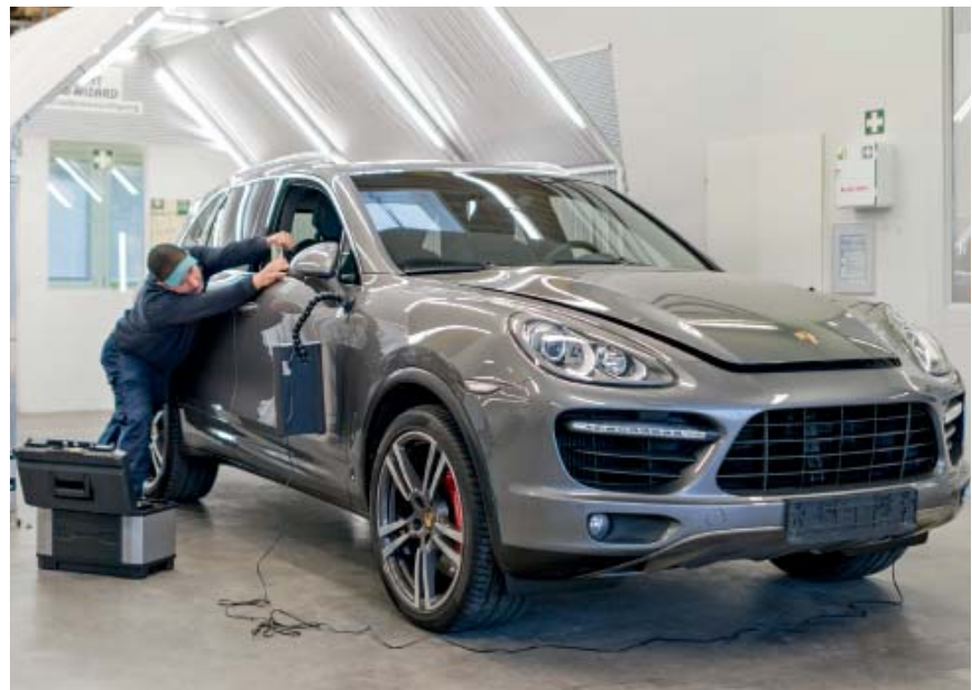
Bild aus der Praxis, Hagelschadeninstandsetzung eines Dent Wizard Technikers im Dent Wizard Service Center
